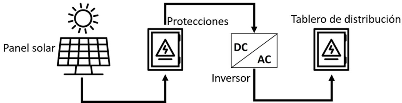
Efectuamos estudios de conexión de sistemas fotovoltaicos basados en mediciones, que permiten verificar el impacto de la conexión del sistema de generación sobre el sistema eléctrico.
